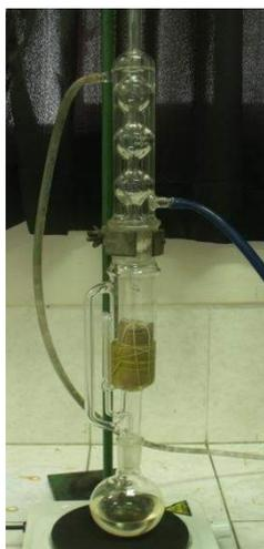
Fig 7. Extracción en el equipo soxhelt
