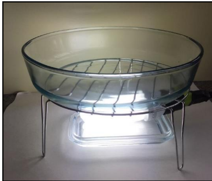
Figura 5 – Equipamento para execução do método Candling table (dissecção sob luz transmitida)
