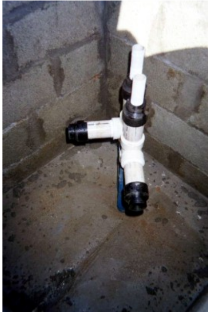
Foto 16- Piezômetro de câmara dupla com saída lateral para leituras de gases. Fonte: UNWELT Consultorias
