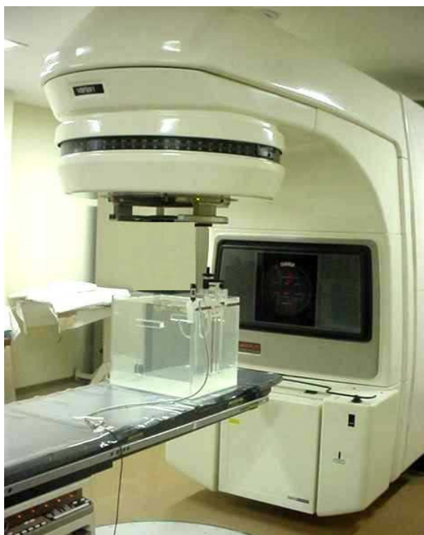
Figura 17 – Montagem experimental: acelerador linear, fantoma e câmara de ionização.
