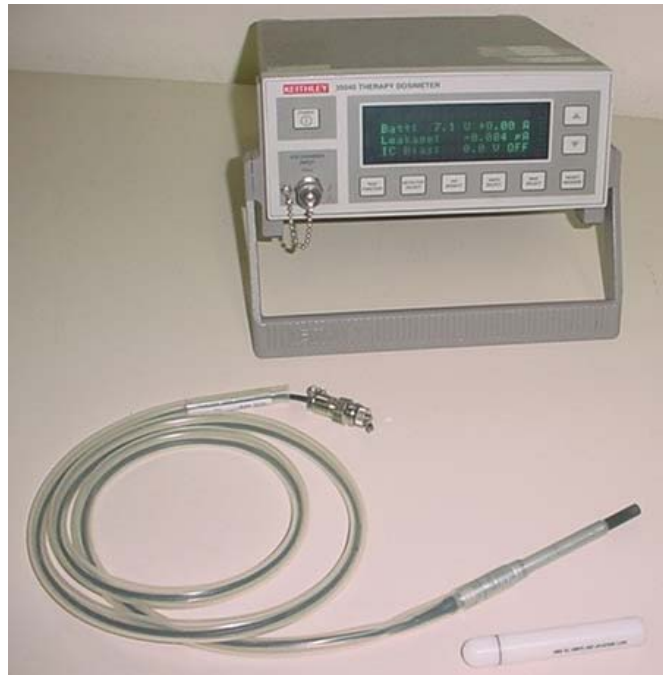
Figura 18 – Conjunto dosimétrico: câmara de ionização IC-70 e eletrômetro Keithley modelo 35040.
