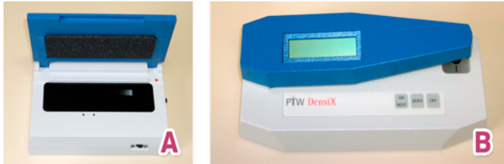
Figura 86. Instrumentos para sensitometria. Em A, sensitômetro; em B, densitômetro Fonte: Acervo SQRI.
