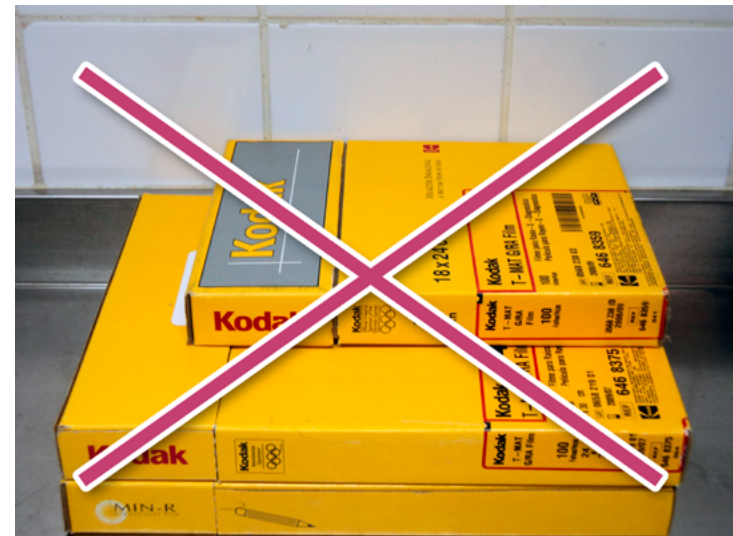
Figura 81. Armazenamento incorreto das caixas de filmes Fonte: Acervo SQRI.
