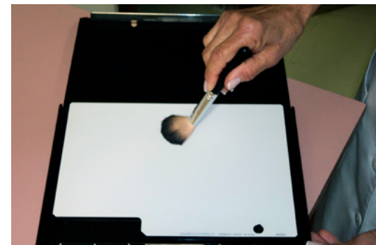
Figura 83. Limpeza de chassi com pincel Fonte: Acervo SQRI.
