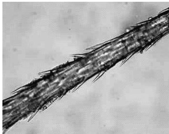
**Figura 2.** Detalhe das farpas laterais dos espinhos de Figo da Índia observadas ao microscópio óptico (aumento 20X)
