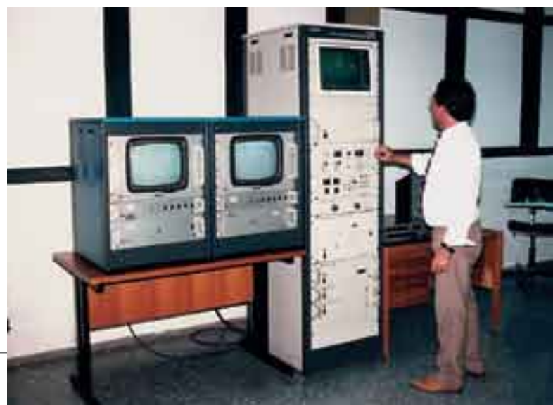
Meteorologista Luiz Cavalcanti operando o Sistema de Recepção de Satélite “Unidade de Análise de Imagens Mestre – UAI-Mestre”, em Brasília. Autonomia no recebimento direto de fotografias de satélites a cada meia hora, no visível, infravermelho e vapor d’água.
