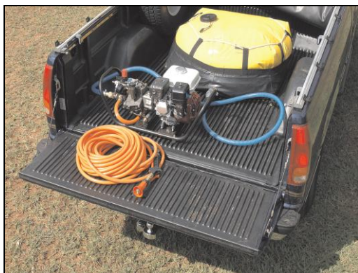
Figura 38: Pulverizador agrícola com tanque de 250 litros
