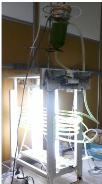
Figura 5. Fotobiorreator tubular do tipo airflit utilizado no cultivo da B. braunii .
