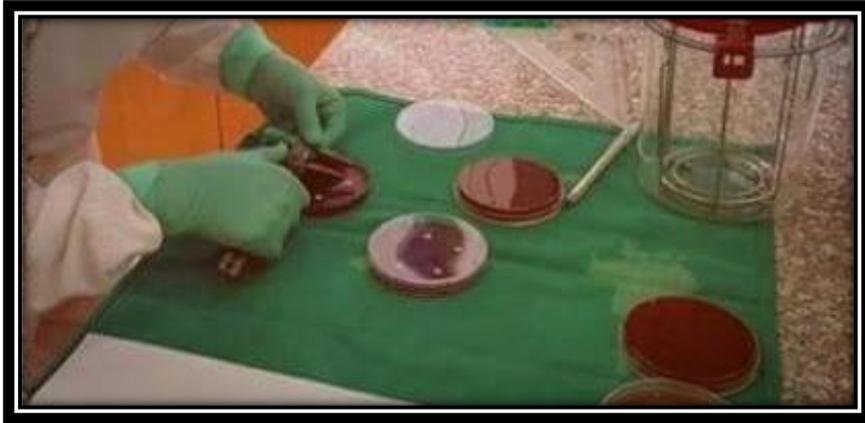
Figura 22. Medición de los halos de inhibición con pie de rey
