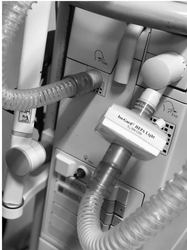
**FIGURA 2:** Filtro HEPA posicionado na saída expiratória do ventilador mecânico. Fonte: os autores. Rio de Janeiro - RJ, Brasil, 2020.
