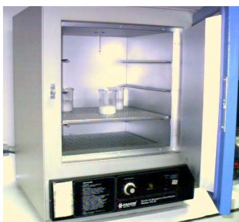
Figura 2.2. Estufa FANEM utilizada na secagem e tratamento térmico pré-irradiação à baixa temperatura.
