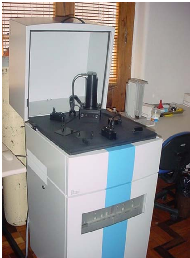
Figura 2.6. Leitora automática PCL 3 utilizada nas leituras dos dosímetros TL.
