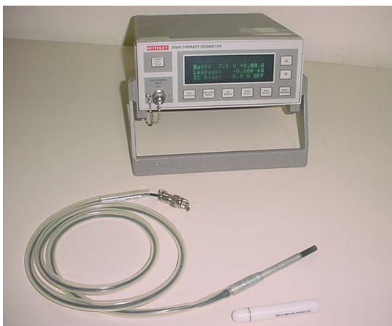
Figura 2.4. Conjunto Câmara – Eletrômetro usado nas dosimetrias de referências.
