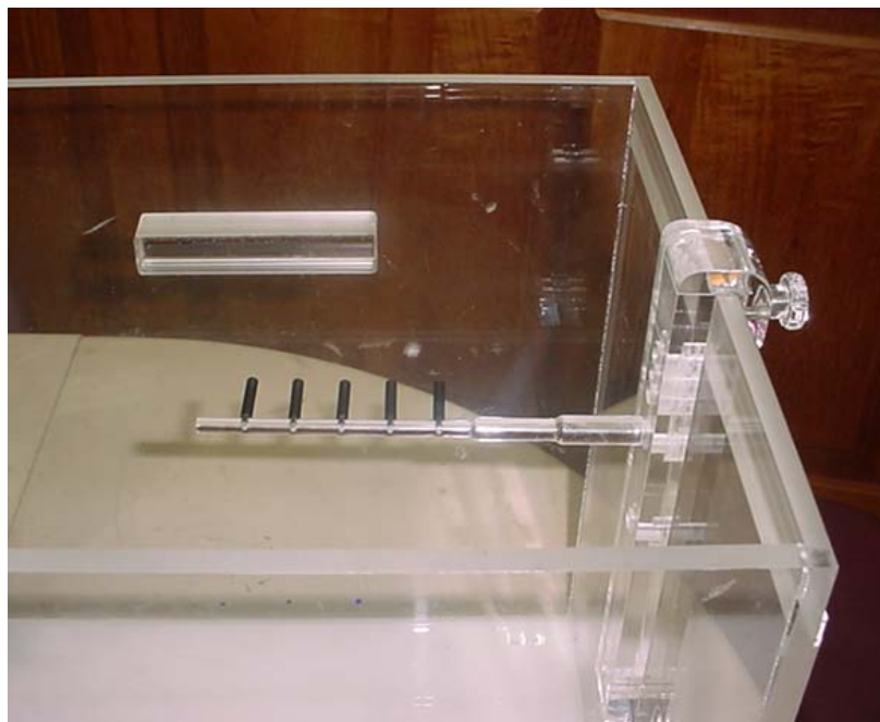
Figura 2.11. Sistema suporte-braço fixado no fantoma para a irradiação dos dosímetros TL que verificarão os diferentes parâmetros a serem testados.
