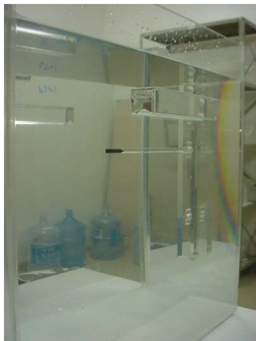
Figura 2.9. Dosímetro TL de calibração fixado no sistema suporte-braço no fantoma na água.
