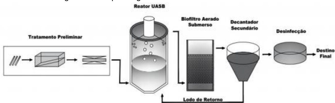
Figura 2.6: Esquema gráfico de uma ETE com reator UASB.
