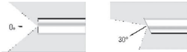
Fig. 13.3.1.2 - Ótica (laparoscópico) com angulações de extremidade de 0° e 30°
