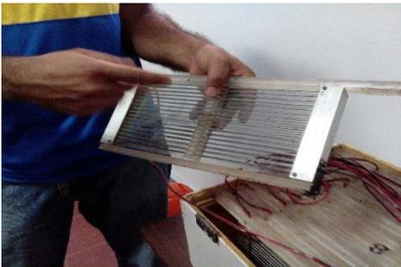
Ilustración 1 Caja con rejillas y placas de vidrio eléctricas (A. Montoya 2018)
