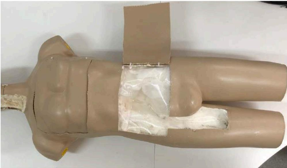
**Figura 05-** Manequim com recortes nas regiões femural, abdominal, torácica e cervical com preenchimento com espuma expansiva de poliuretano e moldagem de canaleta para disposição dos seguimentos arteriais bovinos.
