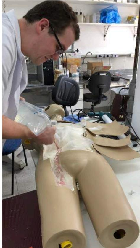
**Figura 06-** Após a disposição dos segmentos vasculares longos, preenchimento das canaletas do manequim com gelatina condutora.
