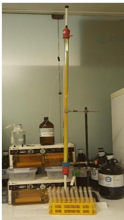
Figura 17: Separação da FrAcOEt em coluna Sephadex LH-20 (2,4 x 70 cm). Foi realizada seis corridas, das quais foram recolhidas aproximadamente 90 frações por corrida.
