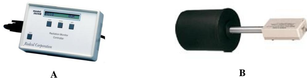
**Figura 07: Sistema detector de radiação. A- Eletrômetro; B-Câmara de ionização 1800cc.**
