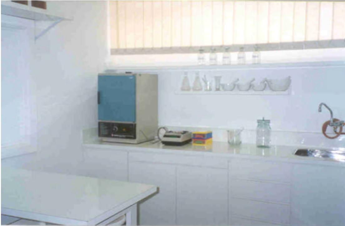
Foto 05 - Bancada medindo 2,80m de comprimento, 0,60m de profundidade e 0,90m de altura para suporte da estufa, da balança de precisão e instalação do lavatório (cuba de inox). Acima da bancada, vê-se prateleira com materiais de laboratório.
