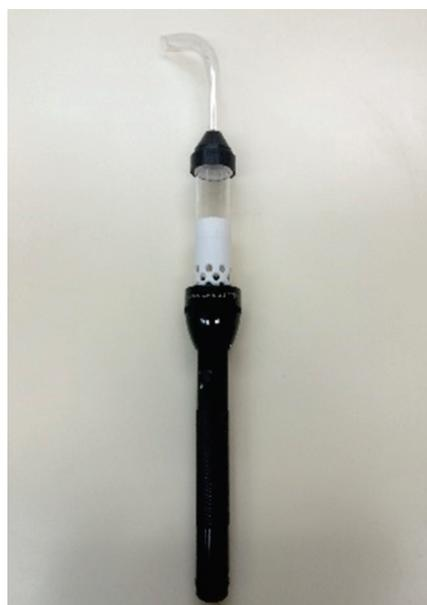
**Figura. 2.** Capturador elétrico para captura de alados
